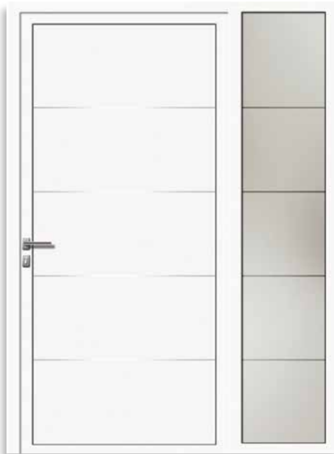
REVA 53 avec tierce Panneau Aluminium Tôle épaisseur 1,8 mm Alu-Nox affleurant Tierce avec vitrage sablé motif clair
